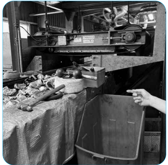
コンベアで流れてくる不燃ごみを分別（中間処理）
