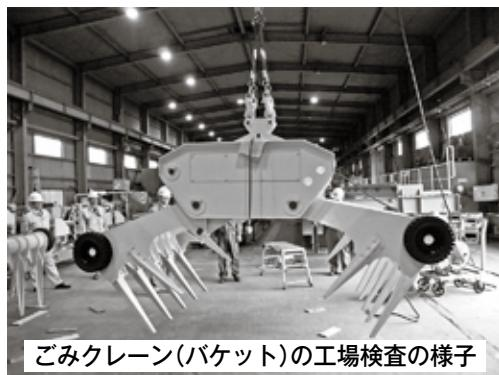
ごみクレーン(バケット)の工場検査の様子
