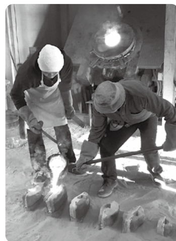
▲銅を型に流し込む作業
