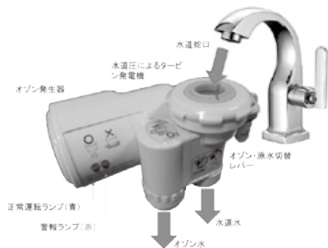
自己発電式ウイルス除菌装置 (ウイルス除菌が可能なオゾン水ができる仕組み(イメージ))
