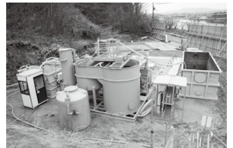
埋設廃棄物の撤去中に濁水が発生した場合は、この装置で除去します
